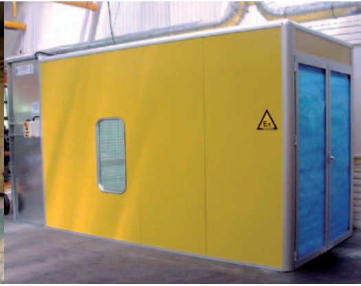
Cabine avec avancée panneaux aluminium et double portes filtrantes.
