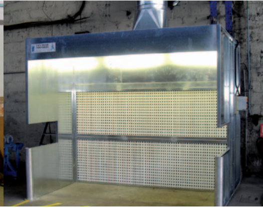
Passage pièces horizontales avec protection
