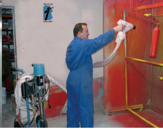
Application airmix électrostatique sur extincteurs.
