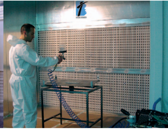
Application basse pression sur pièces plastiques.
