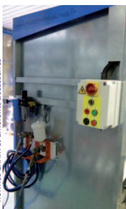
Cabine Mezzo avec son armoire électrique aux normes CRAM et différents accessoires
