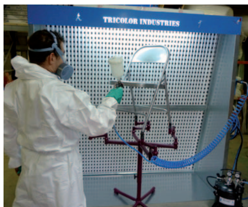
Cabine Mezzo avec son armoire électrique aux normes CRAM et différents accessoires
