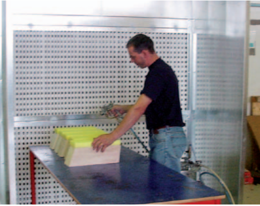
Application colle sur siège de salle de spectacles.
