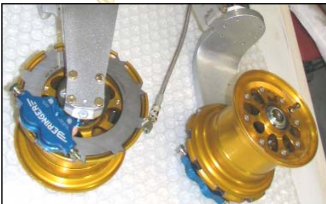
roues et freins BERINGER® montés sur un train d'atterrissage de GLASAIR III de compétition
