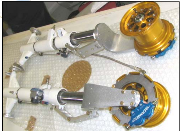
roues et freins BERINGER® montés sur un train d'atterrissage de GLASAIR III de compétition
